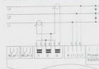
在4线系统中与1个电流互感器连接(负载平衡 $L_n=0$ )
